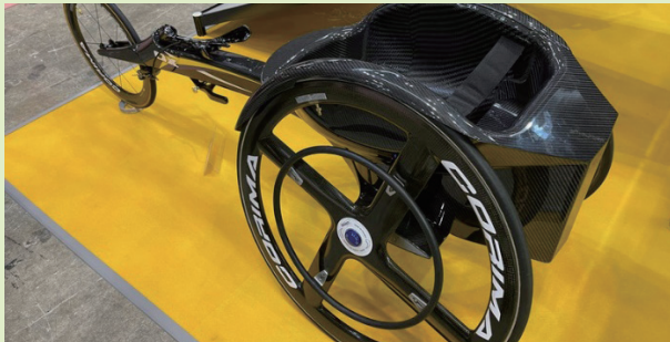
カーボンフレームモデル「CARBON GPX」。車いす陸上の世界でもハイエンドモデルはカーボン製。乗りこなすのは至難の業のようだ。
