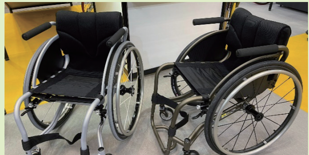
OX エンジニアリング製固定式車いすのハイエンドモデル「XR」。左が従来のアルミフレーム(重量は8.75g)のもので、右がマグネシウムフレーム。
