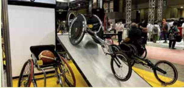
アルミフレーム製陸上用車いすのハイエンド「GPX R24」。アルミのしなる特性が汎用性の高いセッティングを産む
