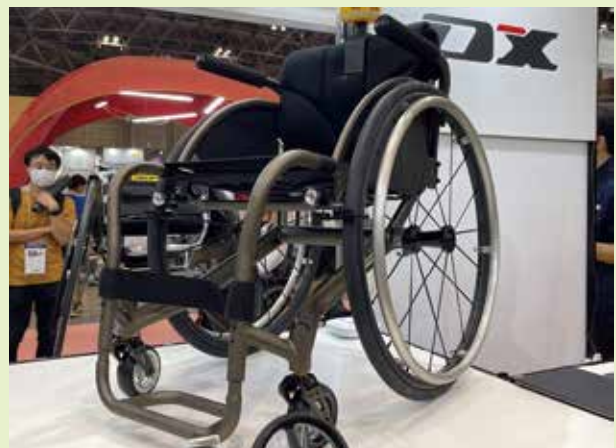
新型XRの重量はそのフレームの太さからは想像できない7.5kgという超軽量! 現行モデルよりも約1kgの軽量化を実現している。
