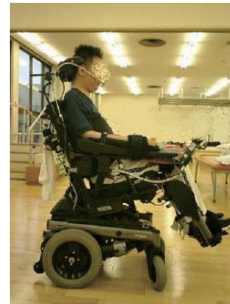
▲電動チルトとリクライニングを装備した電動車いす スイッチ付きのヘッドレストで、電動車いすの操縦と座席の位置変換ができます。
